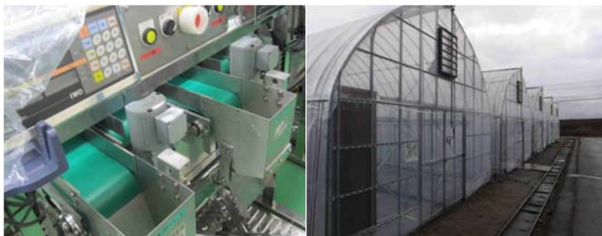
그림 2 생감 무게 측정기 및 무게별 배출구(좌), 껍감 가공센터 및 건조시설(우)
