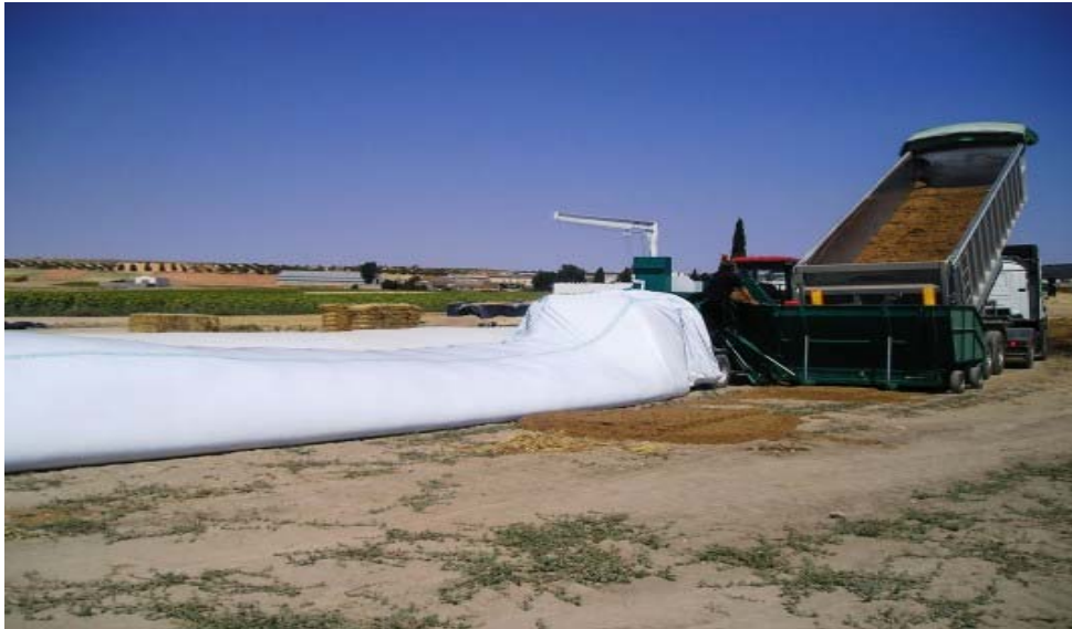
그림 3 수확 후 즉시 노천 저장 방식의 확산(플라스틱 자루 시일로: Silo-bolsas)
