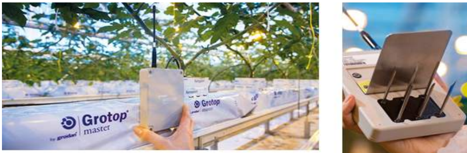
그림 5 근권부 정밀제어용 무선센서
